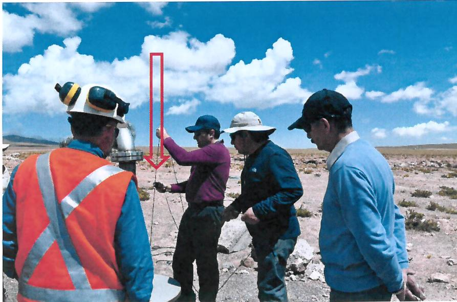
Fotografía 6. Sector de emplazamiento pozo 8B, sistema de medición de profundidad del nivel del pozo.
