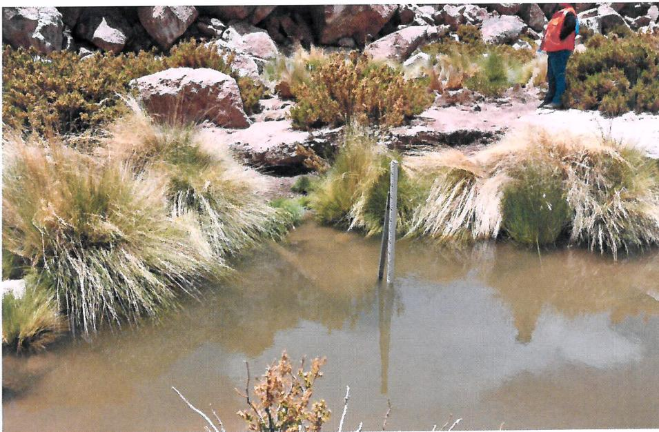
Fotografía 12. Ubicación de regleta metálica en poza 2 vega Sapunta. La regleta de madera se encuentra sumergida.
