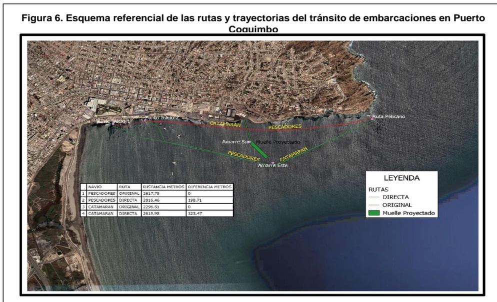
Figura 6. Visualización gráfica que da cuenta de la descripción de las rutas propuestas y distancias teóricas a recorrer por las embarcaciones con ocasión de las obras proyectadas, correspondiente a la Figura 17, Anexo 24 Adenda 1 del EIA del “Proyecto de modernización del Puerto de Coquimbo” ([Ficha del Proyecto: Proyecto de Modernización del Puerto de Coquimbo \(sea.gob.cl\)](http://sea.gob.cl)).
