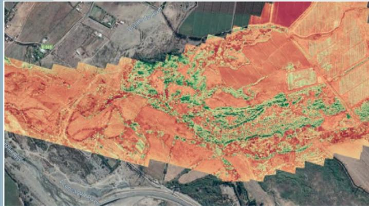
**Causa R-24-2019:** Construcción de Índice de resistencia atmosférica visible (VARI) en la Unidad de Paisaje en Controversia para Revisar condición de Humedad.
